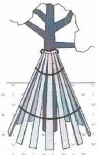
Ehituse ajaks paigaldatav ajutine puu tüvekaitse. Allikas: EVS 939-3:2020 joonis 6.1
